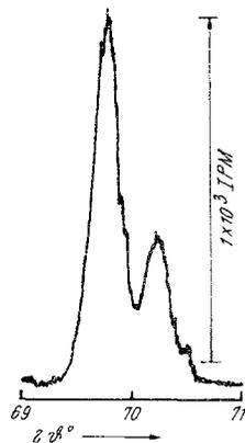
Abb. 1 a. Die  $\text{SK}\beta$ -Strahlung von  $\text{K}_2\text{S}_2\text{O}_7$  mit EDDT-Analysator gemessen
